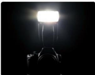
El uso más extendido del **kriptón** se da probablemente en iluminación. Los dispositivos que lo usan generan una luz blanca muy intensa y brillante, por lo que a menudo se usa en flashes para fotografía y en fotografía de alta velocidad. También se emplea en tubos luminosos semejantes a los de neón cuando se quieren obtener colores amarillo-verdosos, para lo cual se mezcla con otros gases en el interior del tubo.
