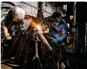
La soldadura por arco eléctrico con gas inerte es una de las mejores soluciones para láminas metálicas de aleaciones de acero inoxidable, aluminio, cobre o magnesio. El proceso de soldadura se realiza manteniendo en la zona un flujo continuo de gas inerte, que impide la oxidación con el oxígeno atmosférico. El gas inerte más utilizado es el **argón**, aunque también puede usarse el helio o una mezcla de ambos.
