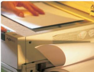
El mecanismo de una fotocopidora consta de un cilindro (o tambor) de aluminio recubierto de **selenio**. El selenio es fotoconductor, es decir, su conductividad eléctrica aumenta al ser expuesto a la luz. Gracias a esta propiedad del tambor, solo se fija el tóner en aquellas zonas del papel donde no llega luz al tambor, con lo que se obtiene una imagen de la página que se quiere fotocopiar.
